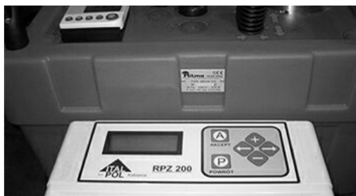
Rys. 36.4 Urządzenie rejestrujące zamontowane w centralce hydraulicznej
