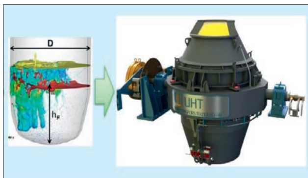
Rys. 1. Schemat konwertora AOD, o pojemności 8 ton w Odlewni PIOMA
