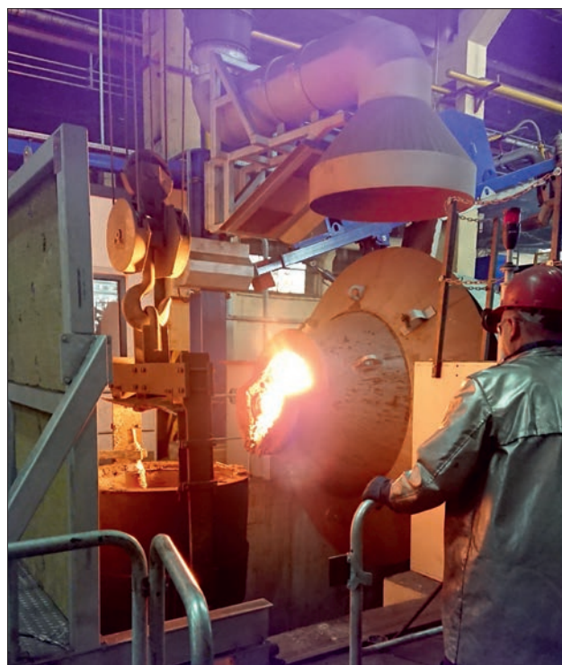
Rys. 4 Przechylenie konwertora AOD do spustu staliwa do kadzi
