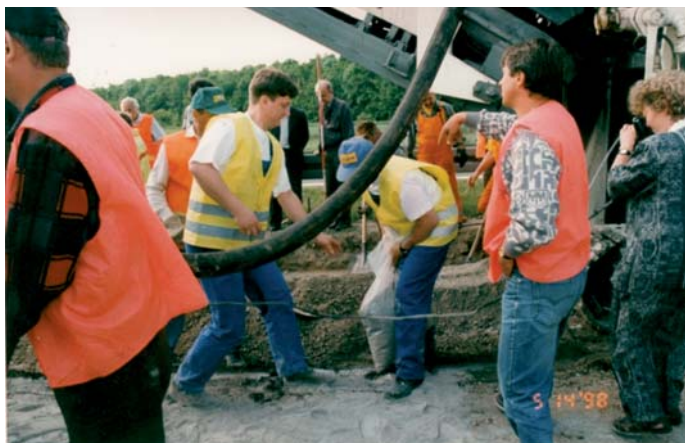
Fot. 8. Pracownicy IBDiM pobierają próbki do badań z jednej z sekcji recyklowanej pierwszego odcinka nawierzchni (fot. K. Jabłoński)
