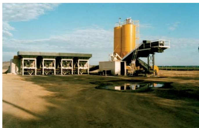
Fot. 10. Widok wytwórni mce firmy Marini o wydajności 250 t/h (fot. K. Jabłoński)
