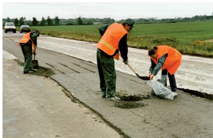
Fot. 9. Pracownicy IBDiM pobierają próbki do badań z kolejnej sekcji recyklowanej nawierzchni w trakcie wykonywania drugiego odcinka próbnego (fot. K. Jabłoński)
