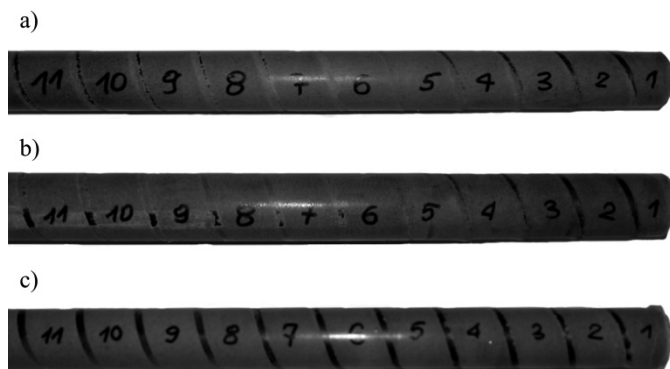
Rys. 11. Wpływ prędkości obrotowej ślimaka na charakterystykę przepływu kompozytu: a) N = 20 obr/min, b) N = 50 obr/min, c) N = 80 obr/min
