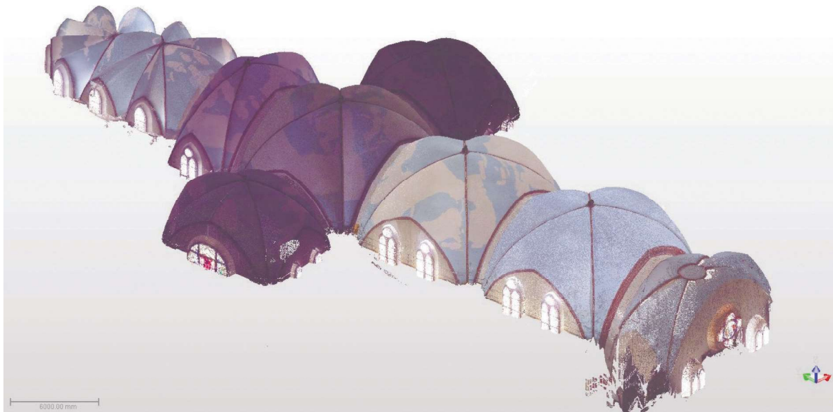
Rys. 26. Model 3D stropu kościoła – wynik przeprowadzonych pomiarów wewnątrz obiektu; widok od strony południowo-zachodniej (Kowalski 2020) Fig. 26. 3D model of the church building roof – the result of surveys carried out inside the structure, south-west view (Kowalski 2020)
