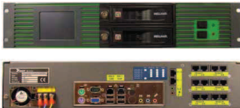
Rys. 1. Widok panelu frontowego i tylnego rejestratora NetCRR2 (fotografia udostępniona przez producenta)
