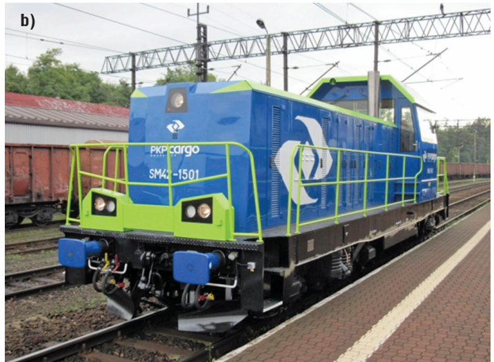
Fot. 1. Zmodernizowana lokomotywa SM42
