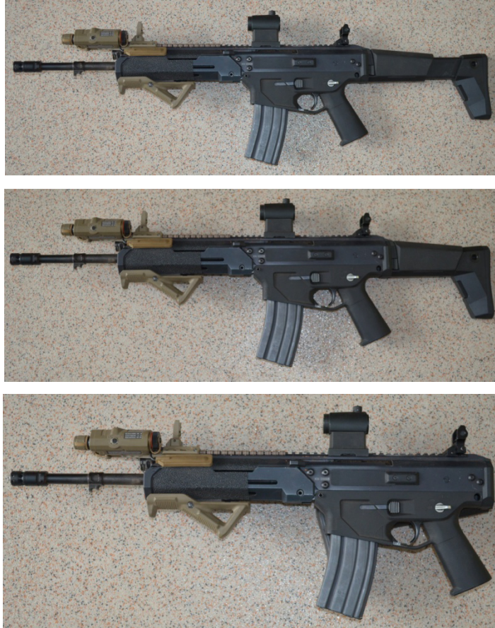
Fot. 2. 5,56 mm karabinek standardowy MSBS-5,56K – strona lewa (od góry): z kolbą rozłożoną i rozsuniętą, z kolbą rozłożoną i wsuniętą, z kolbą złożoną (fot. Wojciech Koperski)
