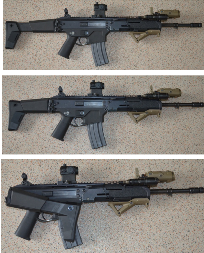
Fot. 1. 5,56 mm karabinek standardowy MSBS-5,56K – strona prawa (od góry): z kolbą rozłożoną i rozsuniętą, z kolbą rozłożoną i wsuniętą, z kolbą złożoną (fot. Wojciech Koperski)
