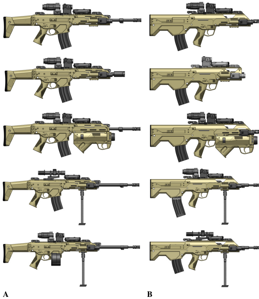
Rys. 1. Docelowa struktura MSBS-5,56: A – MSBS-5,56K (od góry): karabinek podstawowy (standardowy), subkarabinek, karabinek-granatnik, karabinek wyborowy, karabinek maszynowy, B – MSBS-5,56B (od góry): karabinek podstawowy (standardowy), subkarabinek, karabinek-granatnik, karabinek wyborowy, karabinek maszynowy
