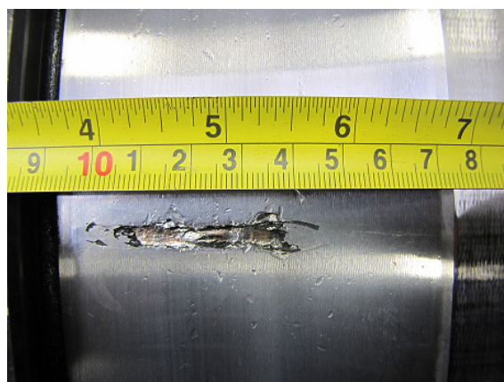
Rys. 8. Widoczne głębokie złuszczenie bieżni oraz ślady zawalcowania wyrwanych fragmentów bieżni
