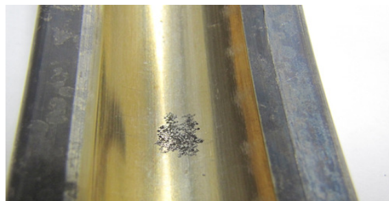
Rys. 12. Zdemontowane łożysko 6034 z przedmiotowego silnika podczas prac remontowych przeprowadzonych na unieruchomionym silniku.. Widoczne są kraterki na bieżni łożyska powstałe na skutek przepływu prądu przez łożysko
