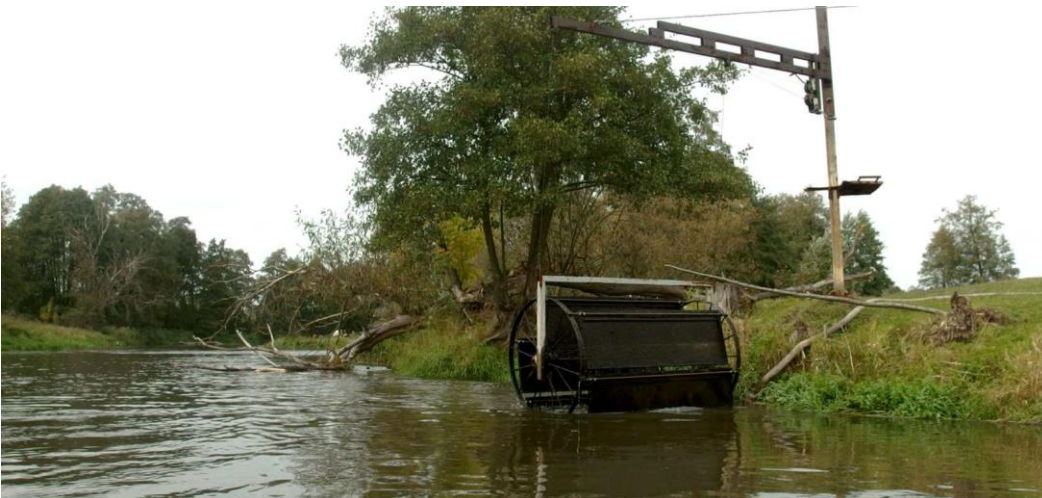
Fig. 9. A winch pumping water for watering cattle in Serniki village. Source: author Ryc. 9. Kołowrót pompujący wodę do pojenia bydła we wsi Serniki. Źródło: autor
