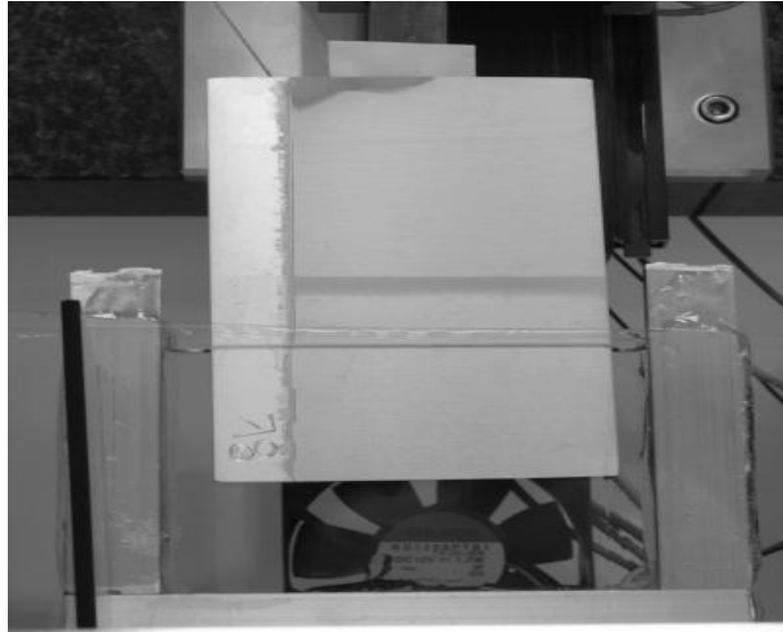
Rys. 4. Laboratoryjne nanoszenie warstwy silanowej Fig. 4. Laboratory deposition of silane layer
