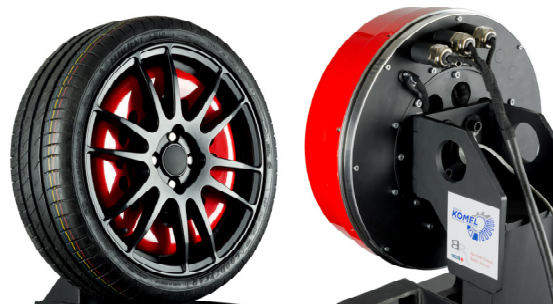
Rys. 1. Wykonany prototyp silnika do zabudowy w kole
