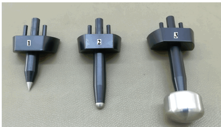
Rys. 4. Końcówki rozładowcze wykorzystywane podczas badania ESD
