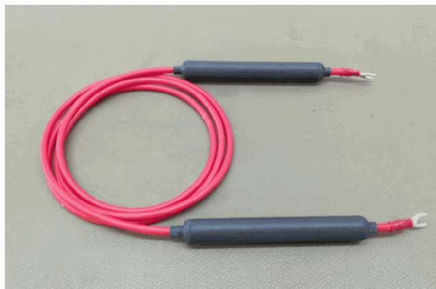
Rys. 5. Rezystory rozładowcze o wartości 470 k \Omega
