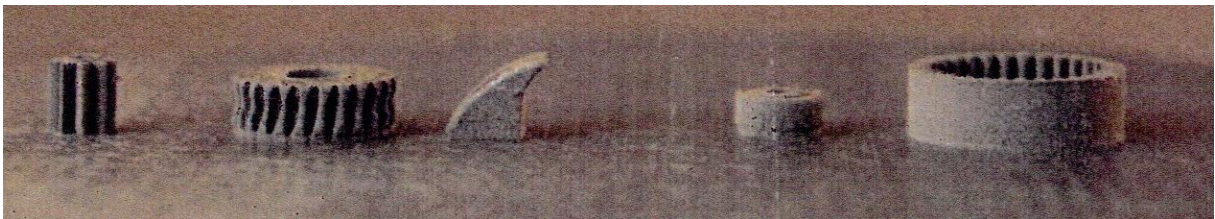
Rys. 8. Zbiór 5 detali robota wytworzonych przez firmę EOS GmbH GmbH – Betriebsstatte Chemnitz, Niemcy
