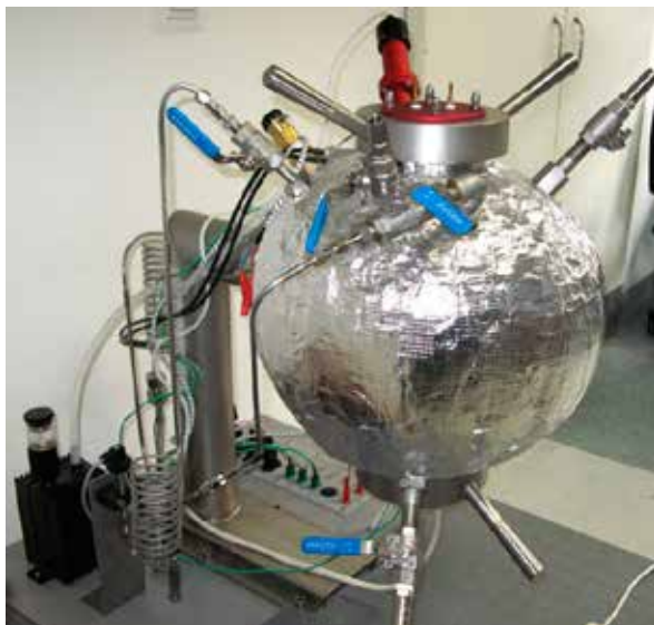
Rys. 1. Zbiornik badawczy do oznaczania parametrów wybuchowości gazów i par cieczy
