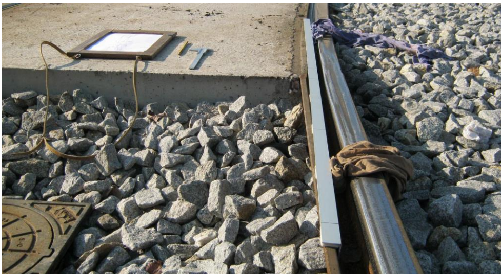
Rys. 6. Pomiar kanciastości szyny w łuku na pętli Oporów
