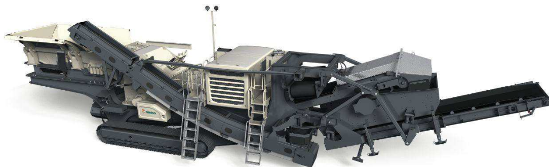
Rys. 11. Układ mobilny Lokotrack LT z kruszarką bijakową NP1213M [20]
