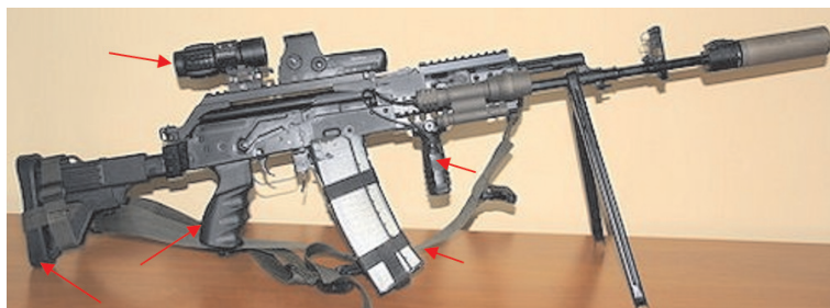
Rys. 7. Karabinek „Beryl” z zaznaczonymi elementami z tworzyw sztucznych
