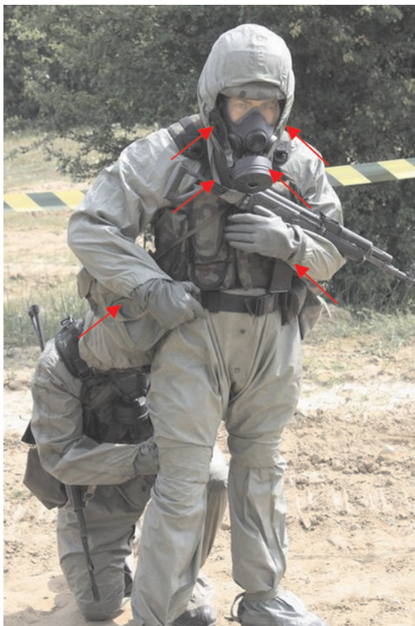
Rys. 5. Prawdopodobne miejsca przenikania par BST pod odzież ochronną
