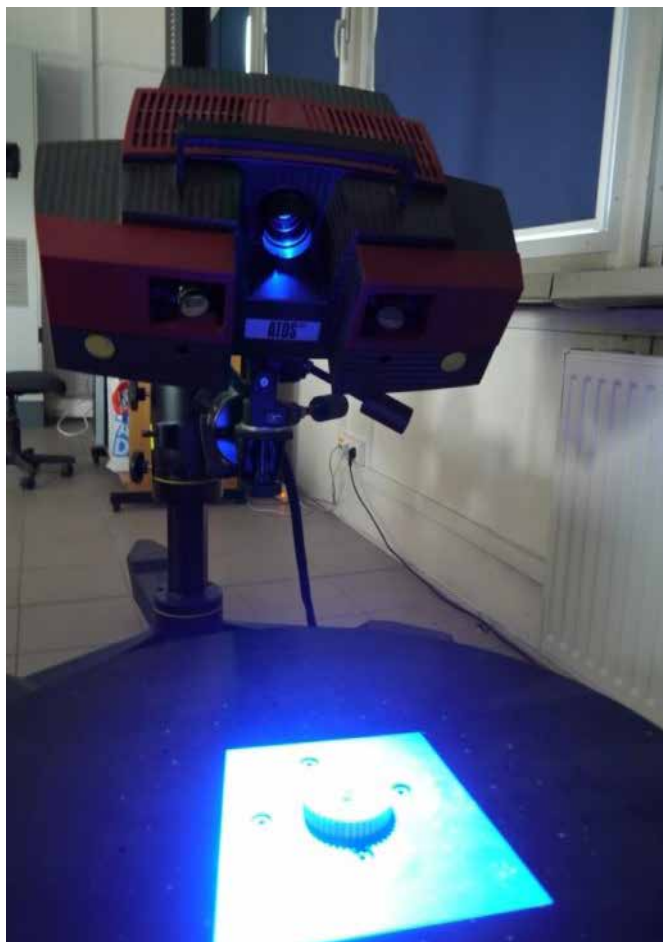
Rys. 9. Optyczny skaner 3D Atos II Triple Scan
