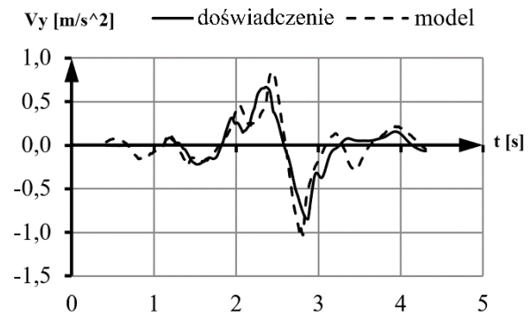
Rys. 10 Charakterystyka prędkości punktu oznaczonego markerem B na kierunku pionowym w funkcji czasu
