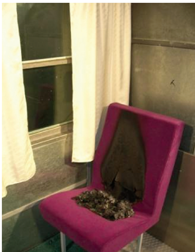
Narożnik przedziału wyposażony w materiały spełniające wymagania PN podczas testu w skali naturalnej
