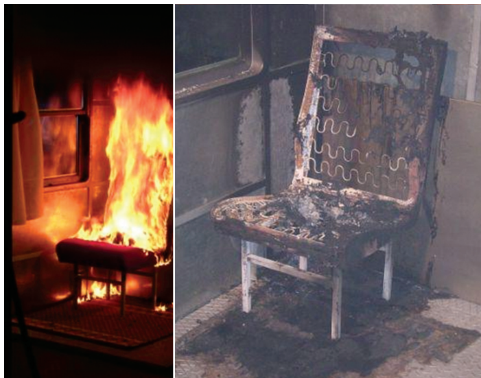
Narożnik przedziału wyposażony w materiały niespełniające wymagań PN podczas testu w skali naturalnej
