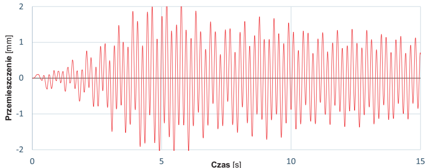
Rys. 14. Lokalne drgania poziome wieszaka w płaszczyźnie wieszaków – przejazd 180 km/h
