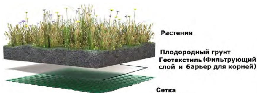
Рис. 5. Схема устройства «сэндвича» под зелёные насаждения
