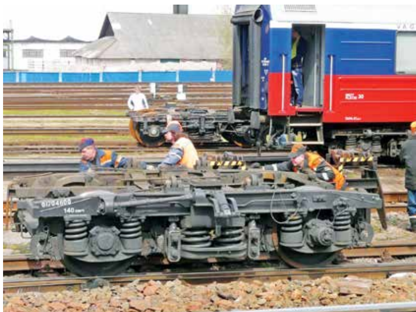
Wymiana wózków w wagonach, Brześć (2.04.2010 r.). Fot. M. Kulgejko
