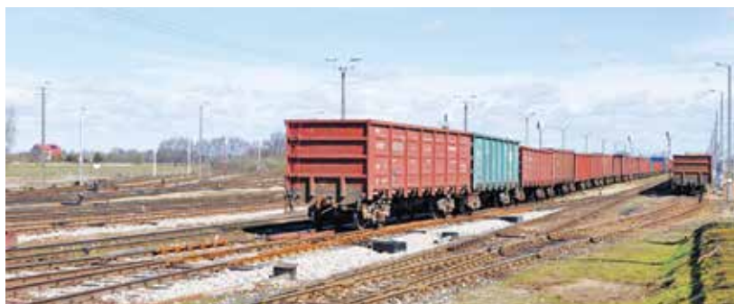
Węglarki serii 12-119 należące do BC i RZD na stacji Kobylany (1520 mm) (2.04.2016 r.)
