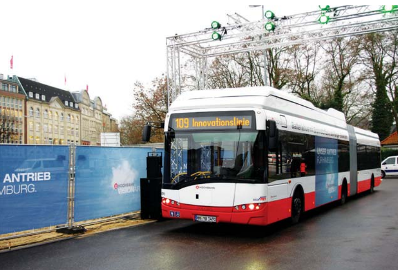
Solaris Urbino 18,75 electric z wodorowym ogniwem paliwowym na linii 109 w Hamburgu. Fot. Solaris.
