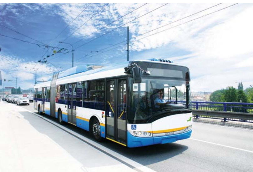
Solaris Trollino z ogniwem paliwowym umożliwia w stolicy Łotwy obsługę linii komunikacyjnych bez dostępu do sieci trakcyjnej. Fot. Solaris
