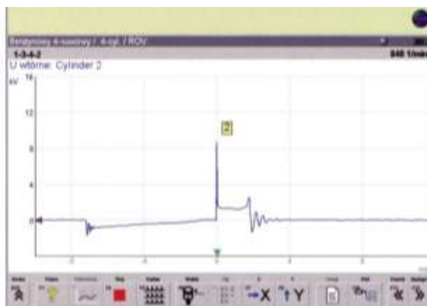
Rys. 6. Wykres prądu w uzwojeniu wtórnym dla jednego cylindra [11]
