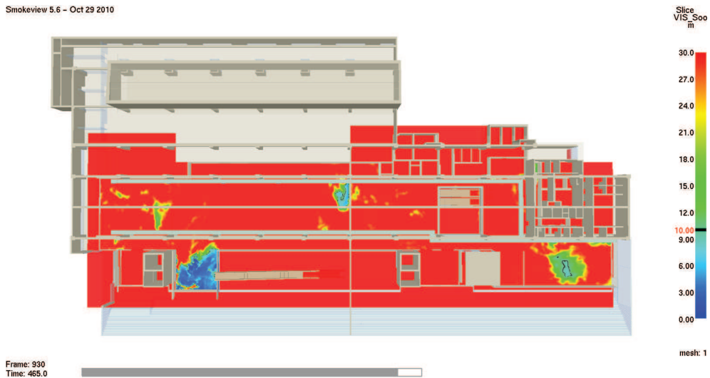
Rys. 4. Przykład rozkładu zasięgu widzialności na wysokości 1,8 metra. Wizualizacja w programie Smokeview Źródło: opracowanie własne.
