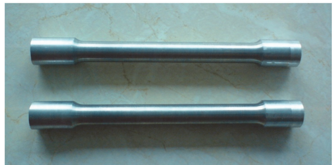
Rys. 2. Próbki do badania wytrzymałości na rozciąganie oraz wydłużenia
