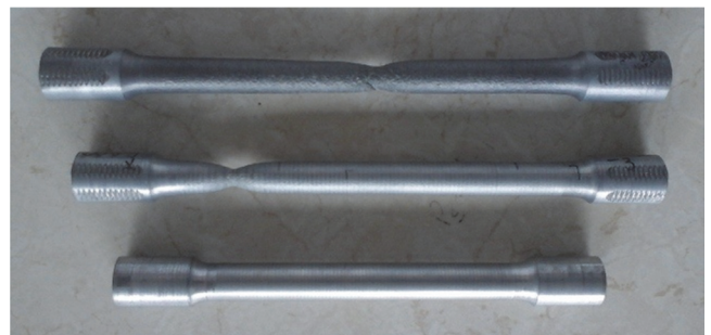
Rys. 3. Obrazy próbek przed i po próbie rozciągania
