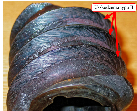
Rys. 3. Uszkodzenia typu II stwierdzone dla segmentów uszczelniających ślimaka [6].
