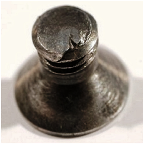
Rys. 1. Pęknięcie zmęczeniowe na wskroś śruby z łbem stożkowym M10x25 [6].
