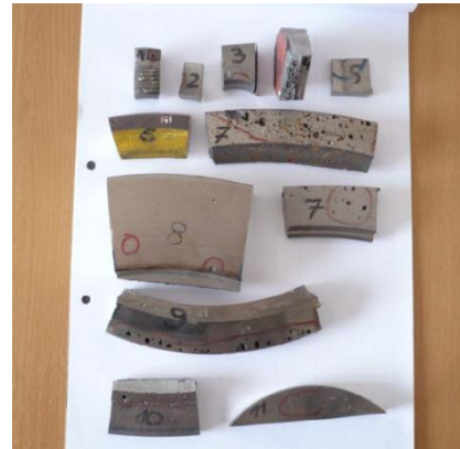
Rys. 6. Zestaw próbek wyciętych z problematycznych odlewów
