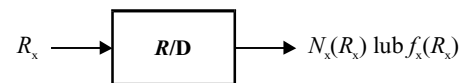
Rys. 7. Analogowo-cyfrowy zrównoważony mostek rezystancyjny. ( R/D ) - jednoetapowa realizacja cyfrowego pomiaru rezystancji Fig. 7. A/D balanced DC resistance bridge as a resistance to digital signal converter (one stage conversion)
