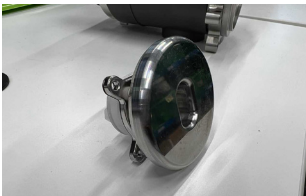
Fot. 8. Emiter elektronów na bazie CNT firmy Micro-X. Komercyjna lampa dla potrzeb medycyny ww. firmy (40-120 kV, 90 mA max , maksymalny czas ekspozycji 1500 ms, ciągła moc anody 28 W, masa 2,35 kg) Photo 8. Electron emitter based on CNT by Micro-X Commercial lamp for the medical needs of the above-mentioned company (40-120 kV, 90 mA max , maximum exposure time 1500 ms, continuous anode power 28 W, weight 2.35 kg)
