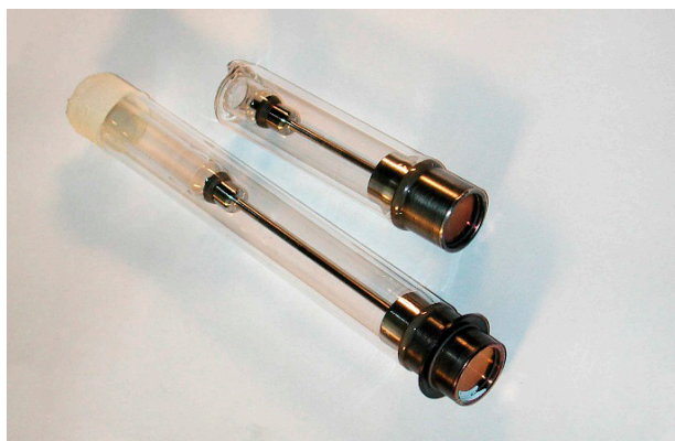
Fot. 3. a) Lampy impulsowe firmy L-3 Communications (USA) b) zużyte anody ostrzowe ze źródła otwartego firmy Scandiflash (Szwecja) Photo 3. a) Pulse tubes by L-3 Communications (USA) b) used spike anodes from an open source company by Scandiflash (Sweden)
