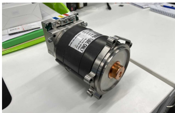
Fot. 8. Emiter elektronów na bazie CNT firmy Micro-X. Komercyjna lampa dla potrzeb medycyny ww. firmy (40-120 kV, 90 mA max , maksymalny czas ekspozycji 1500 ms, ciągła moc anody 28 W, masa 2,35 kg) Photo 8. Electron emitter based on CNT by Micro-X Commercial lamp for the medical needs of the above-mentioned company (40-120 kV, 90 mA max , maximum exposure time 1500 ms, continuous anode power 28 W, weight 2.35 kg)
