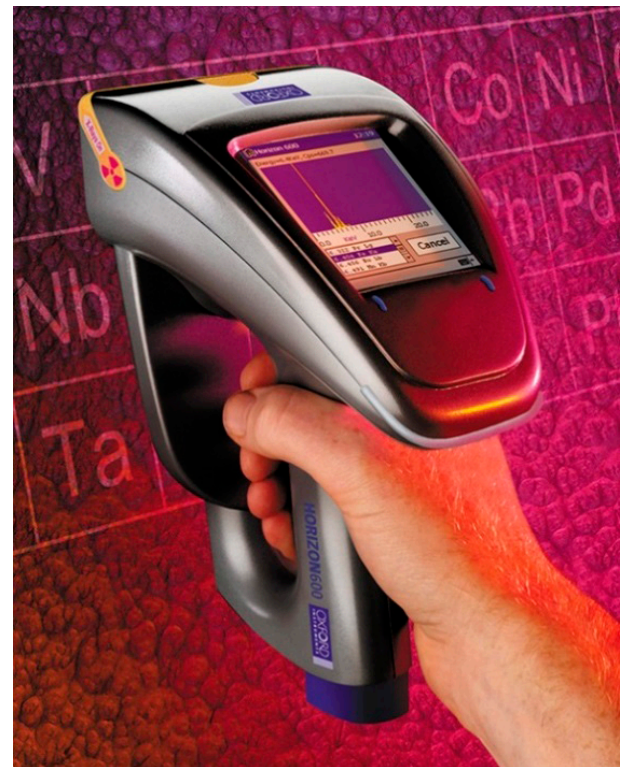
Fot. 6. Przenośny analizator rentgenowski Horizon600 z lampką ze źródłem CNT [10]
