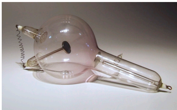
Fot. 1. Jonowa lampa do wytwarzania promieni X (ok.1910 r.) [9] Photo 1. Ion tube for producing X rays (around 1910) [9]
