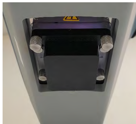
Ryc. 3 Uchwyt MLC QA zamontowany do kolimatora MLC
