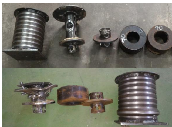
Rys. 5. Elementy absorbera po modyfikacji przed wykonaniem badań oraz po ich przeprowadzeniu
