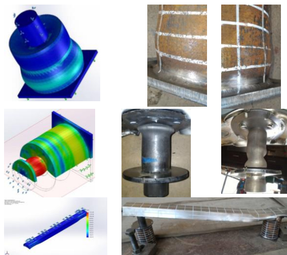
Rys. 4. Porównanie wyników symulacji i badań konstrukcji chroniącej
