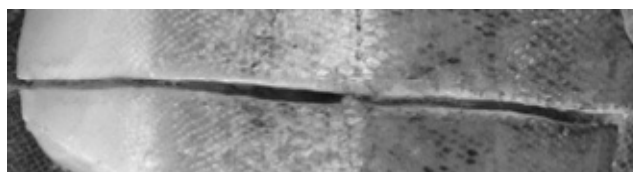
Rys. 11. Efekt zastosowania strugi wypływającej z dyszy o średnicy 1 mm, ciśnieniu zasilania 130 barów oraz prędkości posuwu dyszy 300 mm/min
