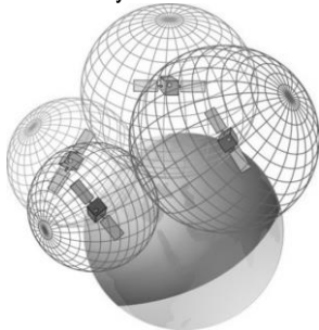
Rys. 6. Model czterech przecinających się sfer o środkach w satelitach. [źródło: http://nadiagpsphysics.weebly.com/how-does-the-gps-work.html ]
