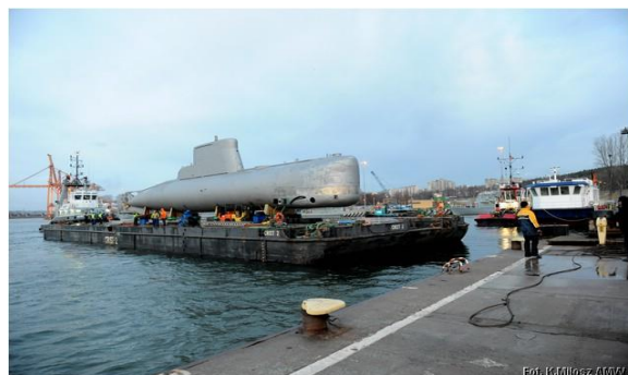
Fot. 5. Okręt podwodny typu 207 podczas przejścia morzem do Portu Wojennego w Gdyni na specjalnym pontonie. Źródło: Archiwum AMW.
