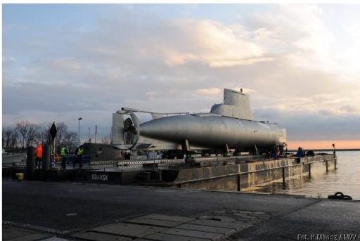
Fot. 7. Okręt podwodny typu 207 podczas przejścia morzem do Portu Wojennego w Gdyni na specjalnym pontonie. Źródło: Archiwum AMW.
