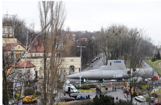
Fot. 8. Okręt podwodny typu 207 podczas etapu przemieszczania na lądzie z Portu Wojennego w Gdyni na tren AMW. Źródło: Archiwum AMW.
