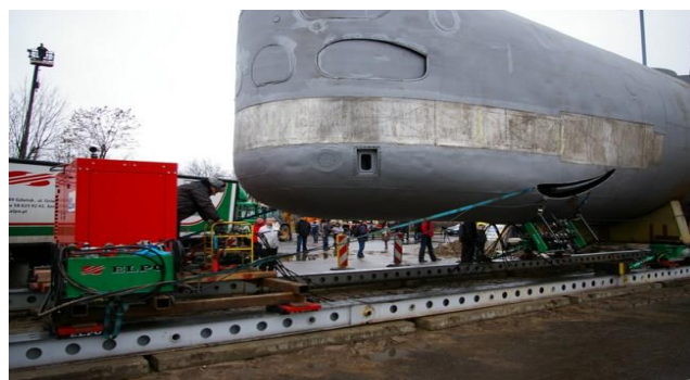
Fot. 10. Okręt podwodny typu 207 podczas operacji przemieszczania na torach skonstruowanych specjalnie w tym celu. Źródło: Archiwum AMW.
