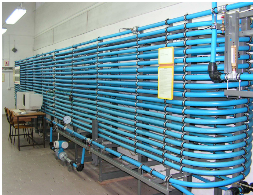
Rys. 5. Widok modelowego rurociągu
