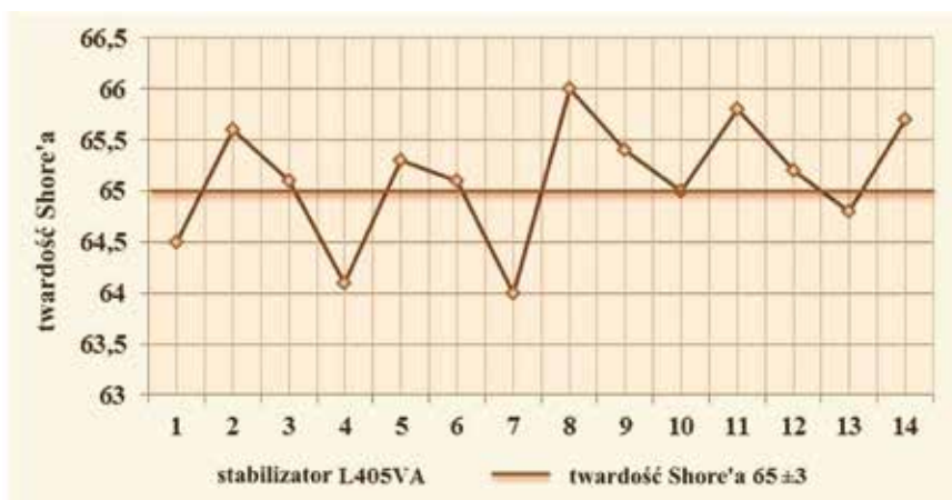
Rys. 15. Pomiar twardości Shore'a łożyska elastycznego stabilizatora L405VA na stanowisku przedstawionym na rys. 14
