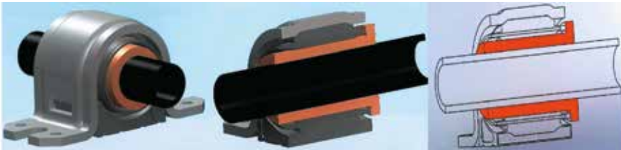
Rys. 7. Przykład łożyskowania stabilizatorów – łożyskowanie przesuwne
