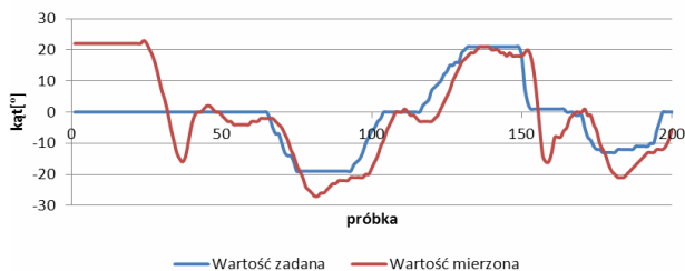
Rys. 7. Odpowiedź obiektu przy zastosowaniu regulatora kaskadowego
