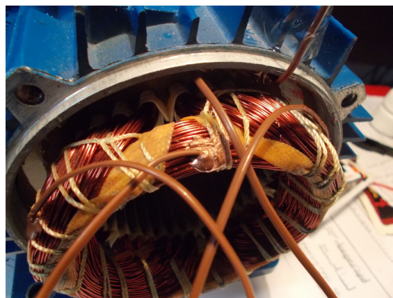
Rys. 14. Miejsce zainstalowania termopar wewnątrz maszyny
