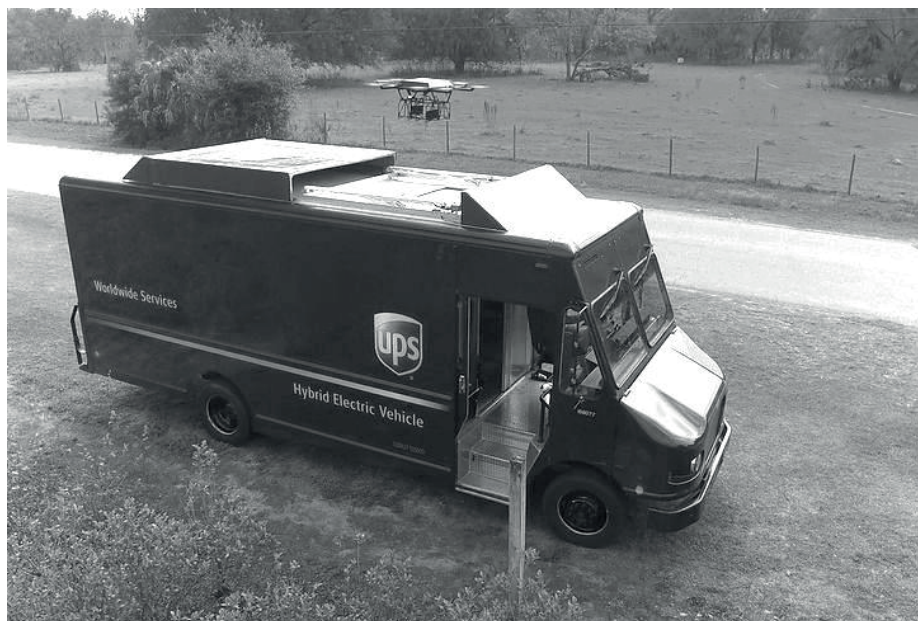
Rys. 5. Hybrydowa ciężarówka firmy UPS będąca bazą dronów [8]
