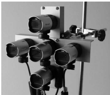
Rys. 1. Układ kamer o nazwie EBMA (Equal Baseline Camera Array) użyty w eksperymentach
