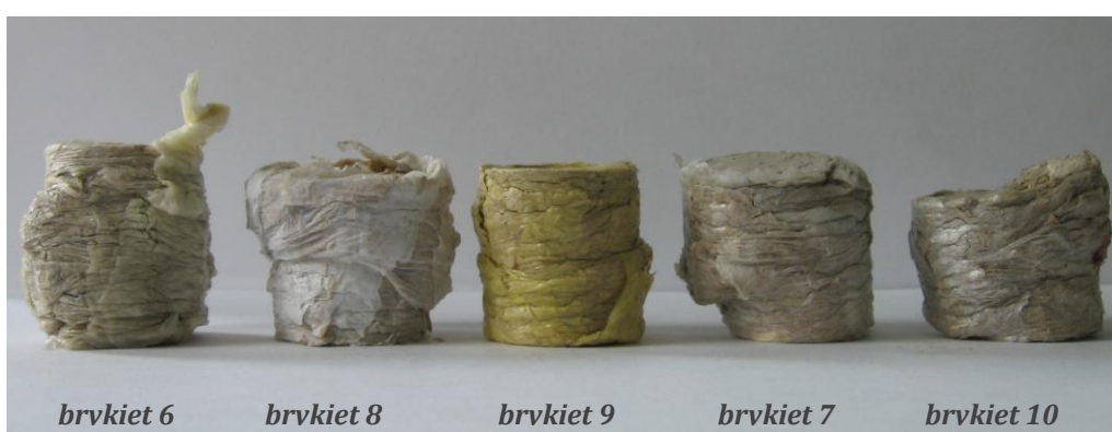
Rys. 2.3.2. Brykiety ze słomy kukurydzy i PE-LD nierozdrobionego po badaniu wytrzymałości na ściskanie wzdłużne (fot. M. Kajda-Szcześniak).
