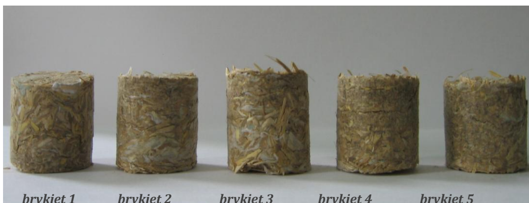
Rys. 2.1.1. Brykiety ze słomy kukurydzy i PE-LD rozdrobionego po badaniu wytrzymałości na zrzucanie (fot. M. Kajda-Szcześniak).
