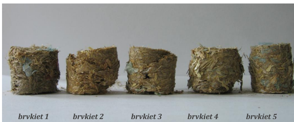
Rys.2.3.1. Brykiety ze słomy kukurydzy i PE-LD rozdrobionego po badaniu wytrzymałości na ściskanie wzdłużne (fot. M. Kajda-Szcześniak).
