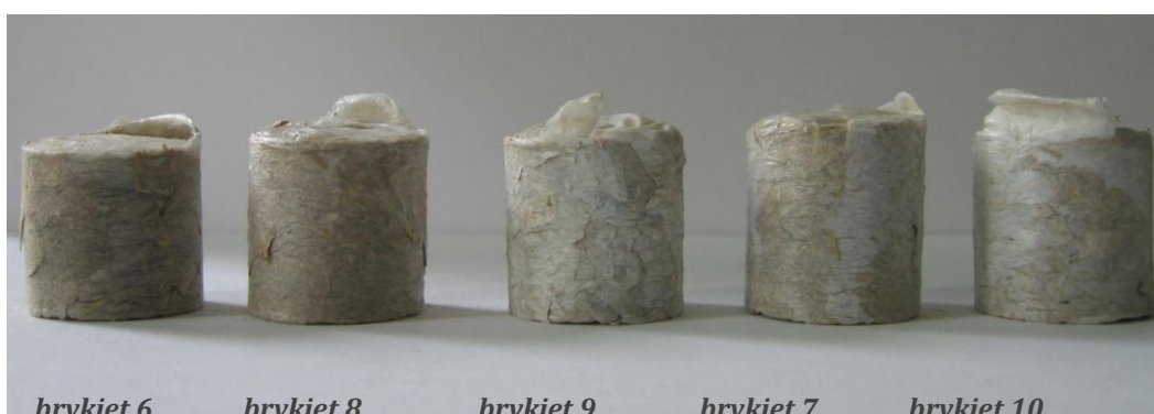
Rys. 2.1.2. Brykiety ze słomy kukurydzy i PE-LD nierozdrobionego po badaniu wytrzymałości na zrzucanie (fot. M. Kajda-Szcześniak).
