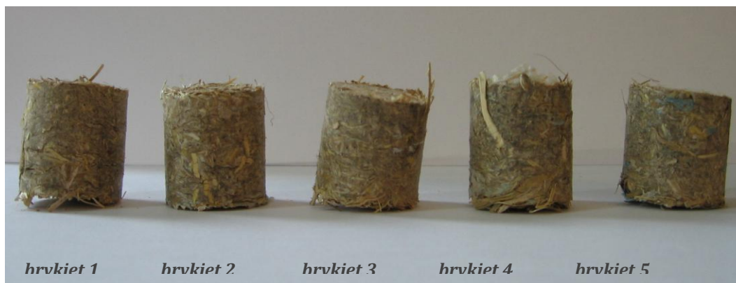
Rys. 2.2.1. Brykiety ze słomy kukurydzy i PE-LD rozdrobnionego po badaniu wytrzymałości mechanicznej metodą bębnową (fot. M. Kajda-Szcześniak).
