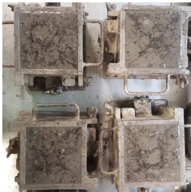
Rys. 3. Próbkę po zagęszczeniu i zdjęciu nadmiaru mieszanki w celu wyrównania powierzchni
