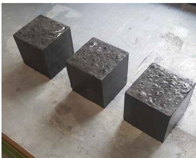
Rys. 6. Przykładowe próbki po badaniu mrozoodporności
