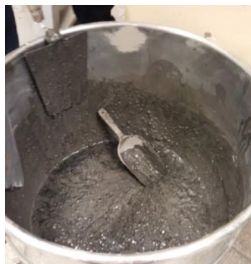
Rys. 2. Gotowa mieszanka geopolimerowa do wykonania próbek
