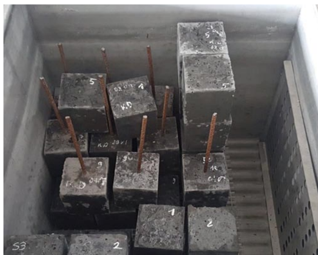
Rys. 8. Próbki do badania pull-out na etapie dojrzewania
