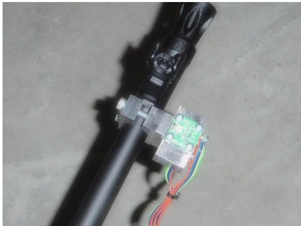
Fot. 2. Kostka z trzema czujnikami akcelerometrycznymi, zamocowana na lufie broni bojowej
