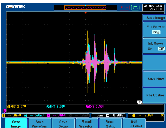
Rys. 8. Przebieg czasowy wibracji bojowego karabinu maszynowego UKM2000P podczas strzału „z ręki” w pozycji leżącej
