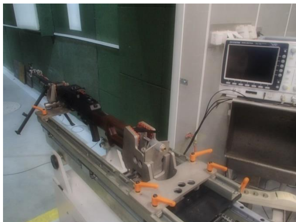
Fot. 1. Bojowy 7,62 mm uniwersalny karabin maszynowy UKM2000P zamocowany na stole badawczym
