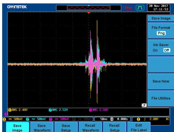
Rys. 7. Przebieg czasowy wibracji bojowego karabinu maszynowego UKM2000P zamocowanego na stole badawczym podczas strzału
