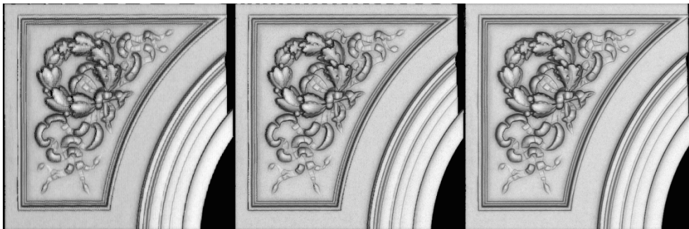
Rys. 13. Sygnał intensywności odbicia zarejestrowany przez skaner skorygowany o kąt pomiędzy kierunkiem widzenia a chwilowym kierunkiem wektora normalnego (wyznaczonego z pewnej liczby punktów sąsiednich)
