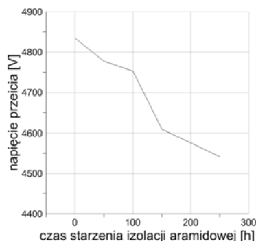
Rys. 4. Zależność napięcia przebicia od czasu starzenia papieru aramidowego
