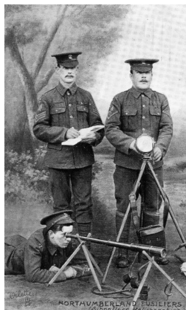
Rys. 1. Heliograf używany przez brytyjską armię. a) rysunek przedstawiający heliograf z wojskowej instrukcji z 1886 roku, b) karta pocztowa z 1906 roku
