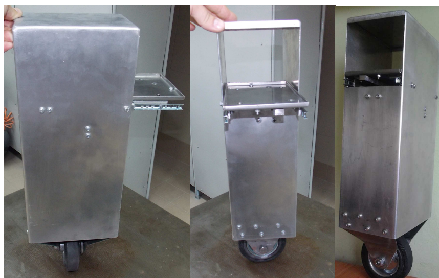
Rys. 12. Wykonana konstrukcja mechaniczna robota z wysuniętą i wsuniętą prowadnicą
