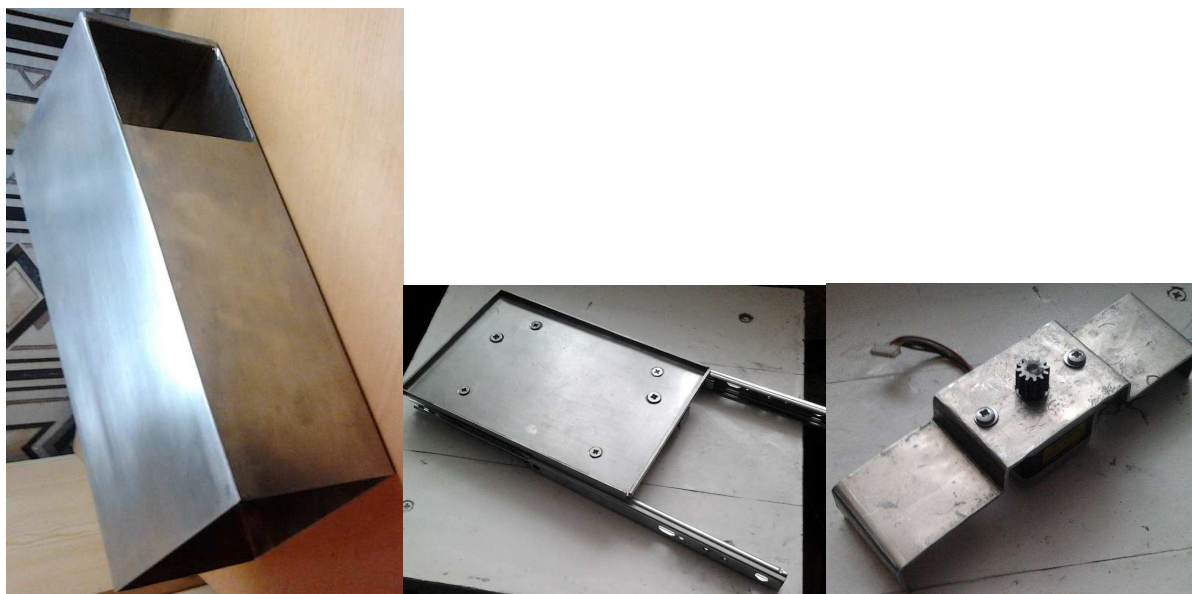
a) b) c) Rys. 11. Fragmenty wykonanej konstrukcji: a) korpus, b) prowadnica, c) silnik krokowy z mocowaniem
